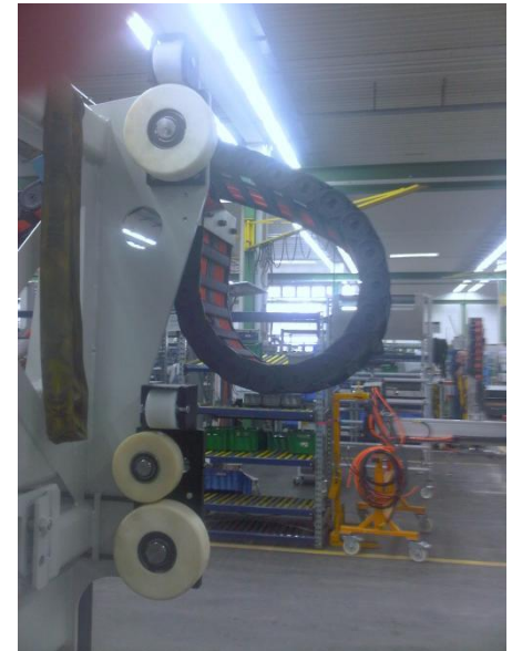
Rouleaux installés sur le support-outils
