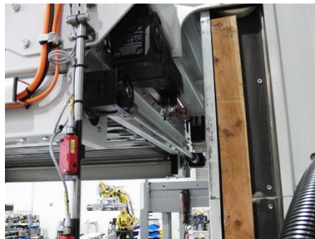
Entraînement et arbre des tapis à rouleaux
